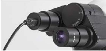
Okularkamera am Tubus befestigt
